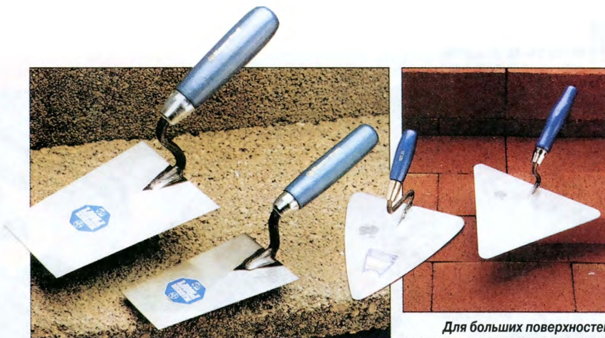
Более удобны для работы штукатурные мастерки с изогнутыми ручками (слева).
