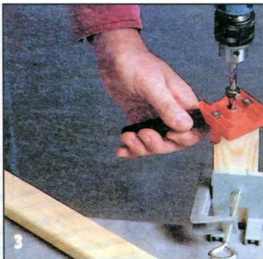
3 Просверлить отверстия под шканты в перемычках боковых элементов точно по центру их торцев поможет кондуктор. Глубину сверления определяет надетое на сверло ограничительное кольцо.
