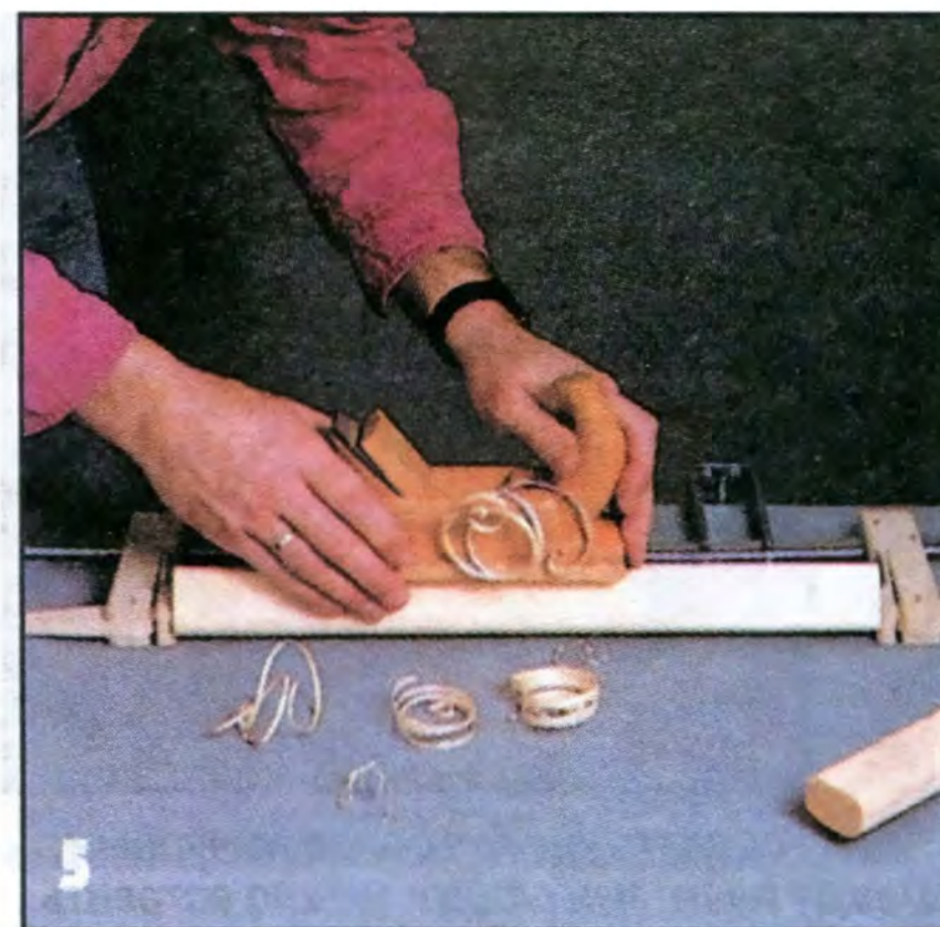
5 Чтобы подлокотники были удобными, им придают слегка овальную форму, прострогав и отшлифовав их кромки. Подлокотники, как и перемычки, соединяют с ножками на шкантах с клеем.
