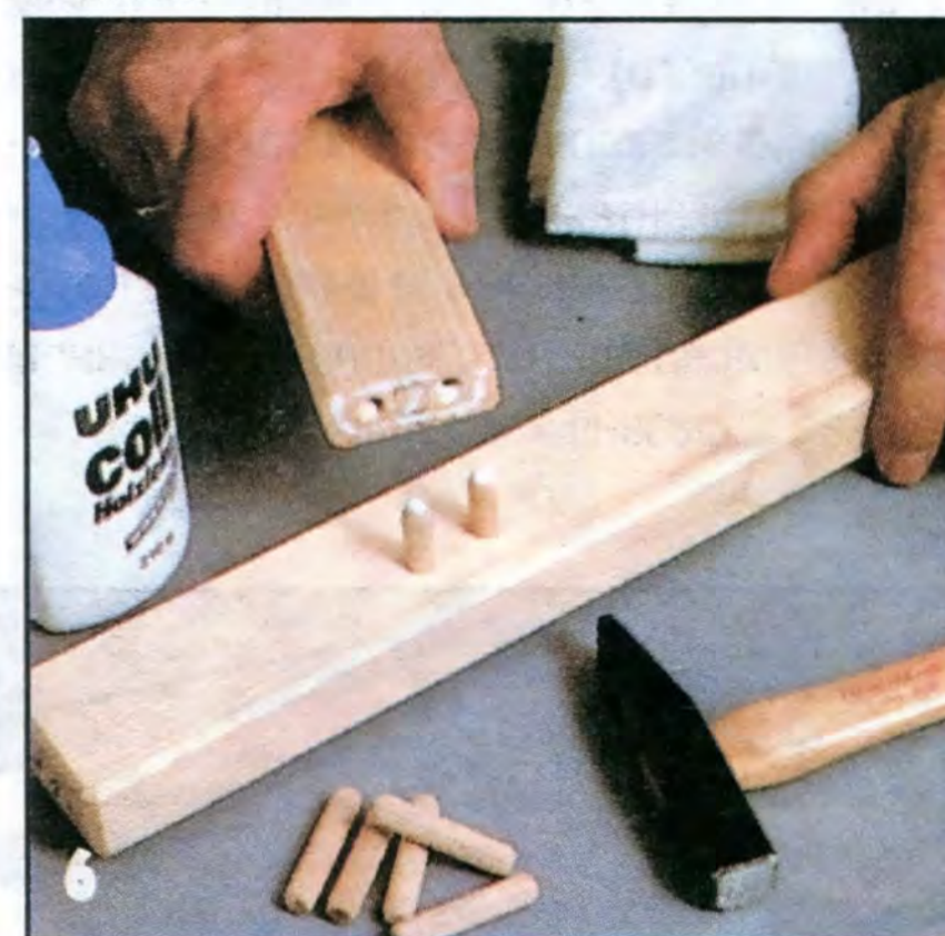
6 Для соединений на шкантах следует использовать водостойкий клей, поскольку мебель будет находиться и на открытом воздухе. Излишки клея необходимо сразу же удалить.
