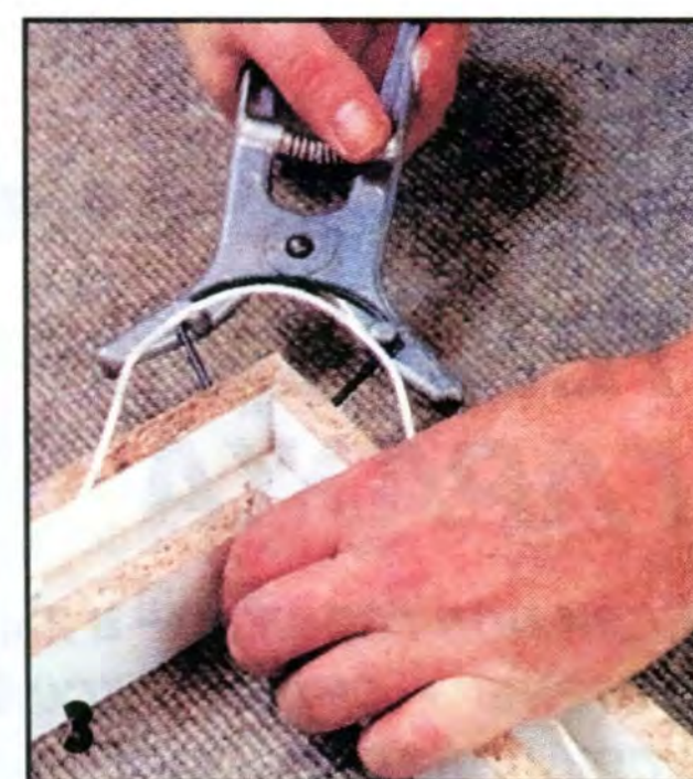
Приподняв провод, скрепляют соединение «на ус» угловой струбциной.
